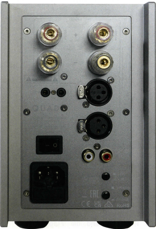
Auf der Rückseite der Endstufe finden wir den Quell-Wahlschalter für XLR oder Cinch und den Schalter, um das Gerät in den Stereo- oder Bridge-Modus zu versetzen
