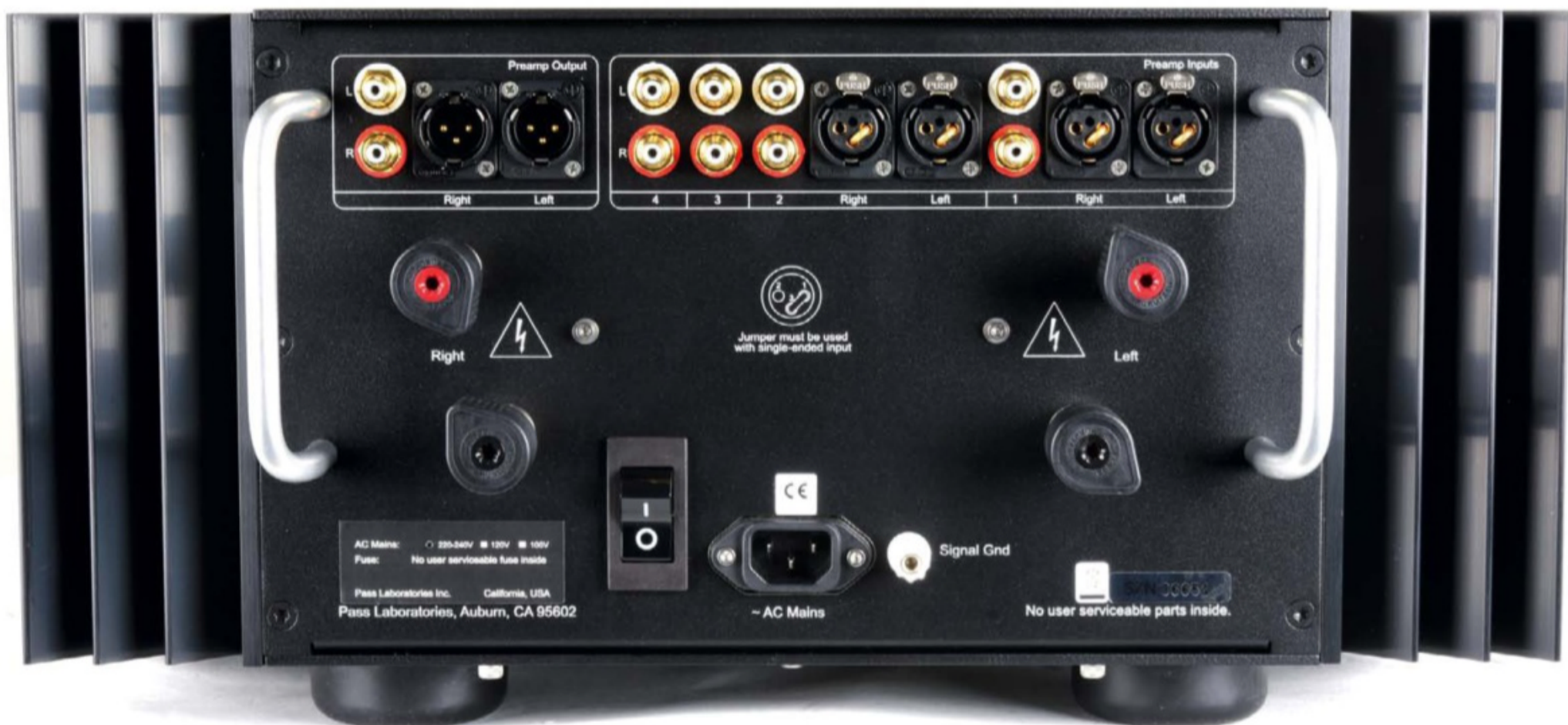
Unsymmetrische Signale werden intern symmetriert. Die Ausgänge mit Linepegel dienen zum Anschluss aktiver Subwoofer oder einer Endstufe. Praktisch: Die großen Lautsprecherklemmen akzeptieren auch Bananenstecker und natürlich die üblichen Gabel-Kabelschuhe.
